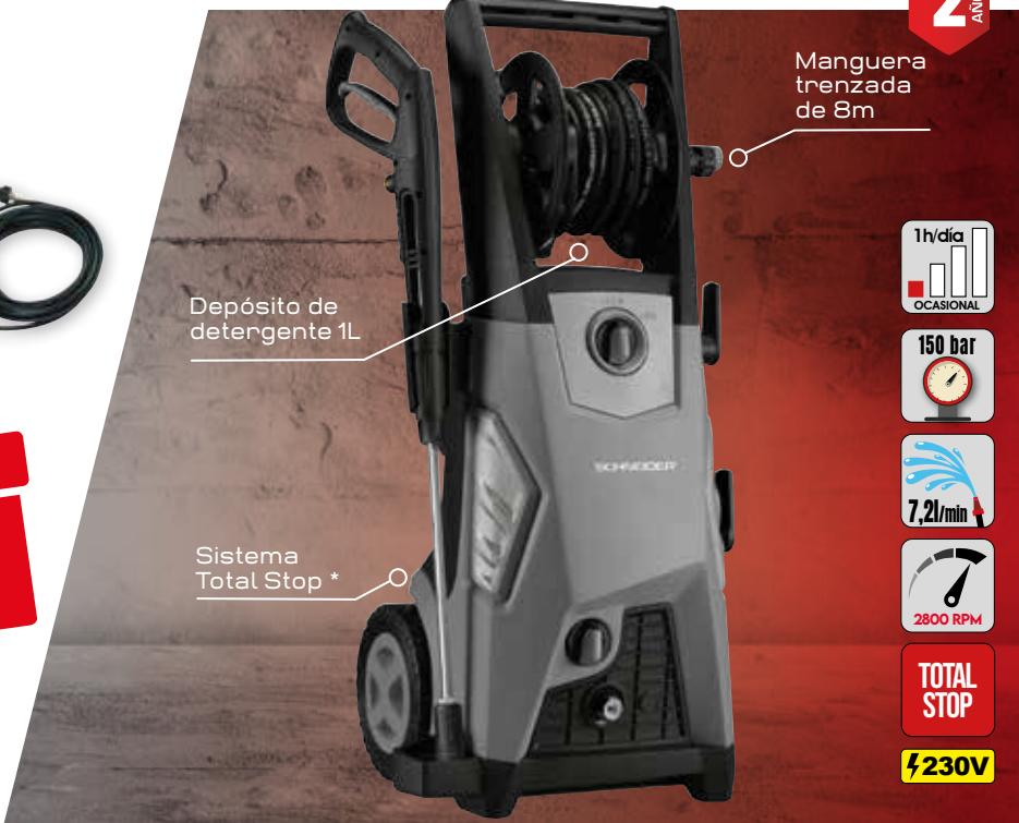
\*Sistema Total-Stop : La protección añadida de las hidrolimpiadoras AP SCHNEIDER. Se recomienda no dejar que la hidrolimpiadora funcione demasiado tiempo en derivación, por eso SCHNEIDER ha equipado las hidrolimpiadoras con un sistema de Total Stop. Esto apaga la máquina cuando se suelta el gatillo de la pistola para evitar el sobrecalentamiento de la bomba.
